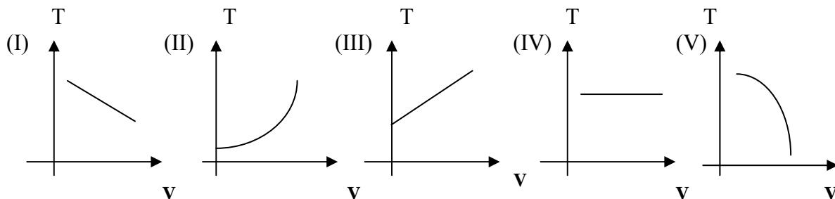
Seja um sistema de vedação a vácuo de vigias a bordo. Suponha que o tempo de resposta de um sistema para chegar-se a 63% da pressão final de vácuo é calculado pela relação  $T = Vx60/Q$ , onde  $V$  é o volume de ar entre o gerador de vácuo e a ventosa de fixação e  $Q$  é a vazão máxima do sistema de tubulação. Dentre os gráficos acima, assinale a alternativa abaixo que melhor representa a variação do tempo com o volume.
