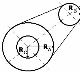
Na figura acima, temos um sistema de transmissão de movimento de um dos motores auxiliares de um navio, formado por três discos A, B e C. Os raios dos discos B e C são iguais e correspondem à metade do raio do disco A. Sabe-se que o disco A move-se solidariamente com o disco B através de uma correia, e que os discos A e C estão ligados ao mesmo eixo central.
